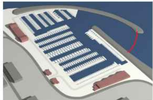
Tancament de la bocana. Amb uns 70 m de barreres.
