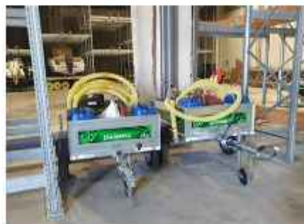
Motobombes aspiració (Nau1)
